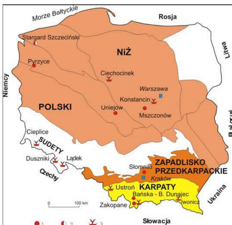
Rysunek 9. Polska – funkcjonujące (1), budowane (2) ciepłownicz zakłady geotermalne oraz uzdrowiska stosujące wody geotermalne (3) w 2005 r. (podział na prowincje i regiony geotermalne wg J. Sokołowskiego red. 1995)
